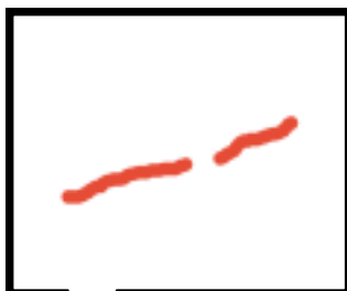
Красная линия говорит о наличии трещины или отсутствии сплавления
